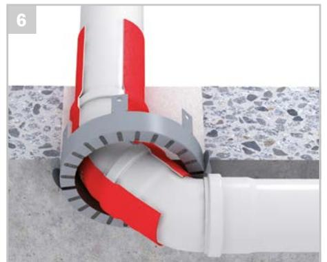
Die AWM II Manschette darf an 2 x 45 Grad Bögen oder schrägen Rohren mit bis zu 3 Abmessungsstufen größer montiert werden.
