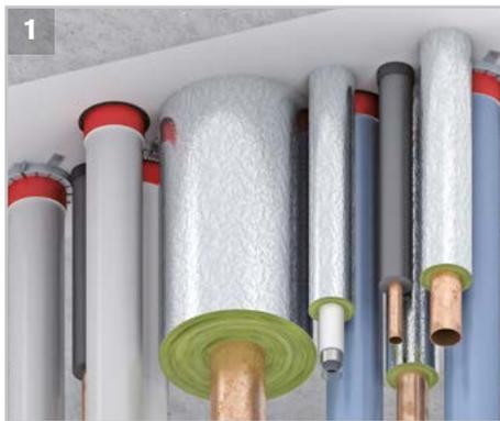
Die AWM II Manschette kann im ROKU® System Nullabstand neben nichtbrennbaren Rohren mit nichtbrennbarer Isolierung bzw. Absperrvorrichtung montiert werden.
